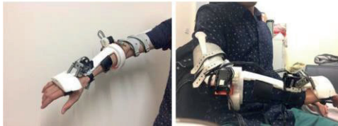
Figura 10. Exoesqueleto de dos GDL con servomotores (Huen et al. , 2016).
