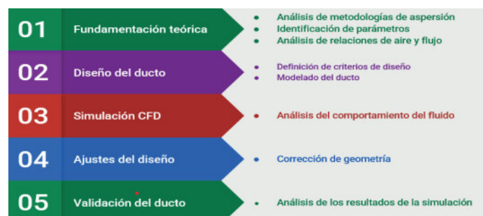
Fig. 1. Metodología para la obtención de un ducto de aspersión basados en principios físicos.
