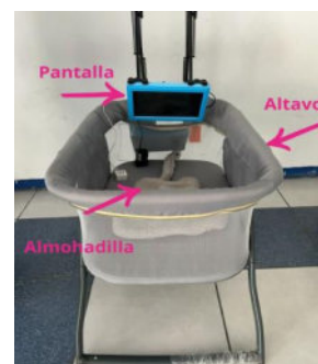
Figura 6. Diseño final del dispositivo que incluye la pantalla táctil, los altavoces y la almohadilla
