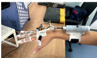
Figura 7. Prototipo de absorbedor magnetorreológico (Yi et al. , 2019).
