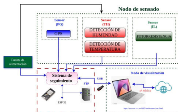
Fig. 1. Representación esquemática de los elementos del sistema de seguimiento solar
