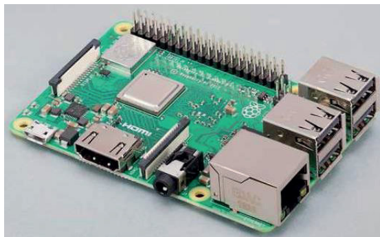
Figura. 5. Minicomputadora Raspberry Pi 3B+ programada con Python para el control y monitoreo del PIR.
