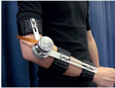
Figura 9. Exoesqueleto para codo, controlado por señales mioeléctricas (Ando et al. , 2012).
