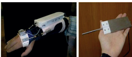
Figura 6. Ortesis de amortiguador de doble tubo y tamaño del absorbedor (Loureiro et al. , 2005).
