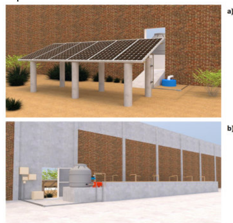
Figura 2. Diseño de panel solar y diseño de la vista inferior del prototipo en 3D.
