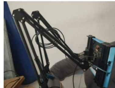
Figura 1. Pantalla táctil ajustable modelo XPT2046, resolución 1024x600 píxeles. Función principal: interfaz de usuario y estimulación visual mediante patrones en movimiento.
