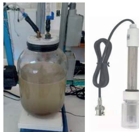
Figura 1. Biorreactor de 3.5 L para la producción de hidrógeno.
