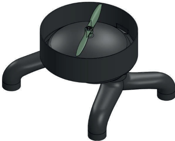
Figura 2. Propuesta de diseño de sistema de sustentación para un dron basado en el uso de un solo motor.
