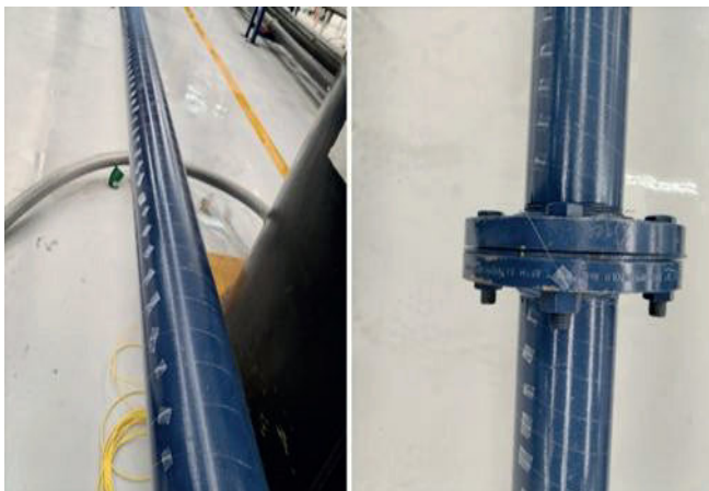
Figura 7. Detalle del enrollado helicoidal de la fibra óptica sobre una sección recta del ducto metálico. También se muestra la forma en como la fibra óptica se coloca sobre una brida.
