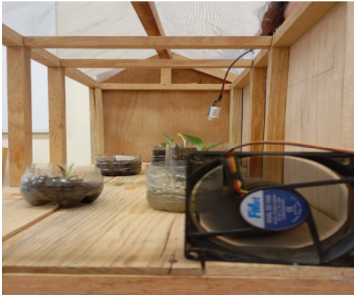
Fig. 8. Instalación de ventilador para deshumidificar la humedad relativa y control de la temperatura
