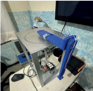
Figura. 12. PIR construido e instrumentado para control y monitoreo.
